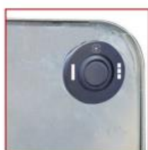
Schakelaar voor de thermostatische ventilatie/doorlopende ventilatie
