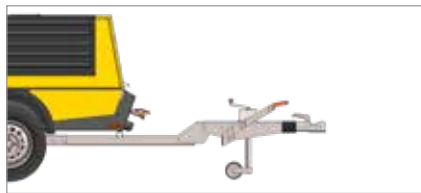
Trekdissel vast met oploop- en parkeerrem
