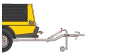
Trekdissel star zonder oplooprem, met parkeerrem
